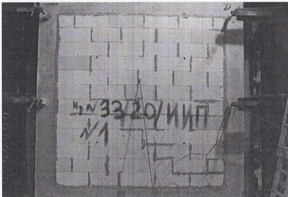
Вид образца № 1 после испытания (сторона огневого воздействия)
